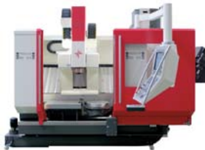
Auch lange Werkstücke bis 1000 mm können auf der RS 505 bearbeitet werden.
