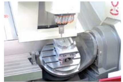
Auch lange Werkstücke bis 1000 mm können auf der RS 505 bearbeitet werden.
