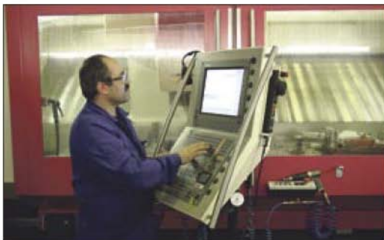
Hazim Oba kontrolliert konzentriert den Fertigungsablauf der CNC-Maschine. Bei den geringsten Schwankungen kann er über die Steuerung direkt eingreifen und Korrekturen vornehmen.
