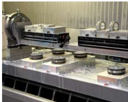
Ausgeklügelte Nullpunkt-Spannsysteme und eine Schwenkbrücke zur Drei-Seiten-Bearbeitung rationalisieren den Fertigungsprozess.
