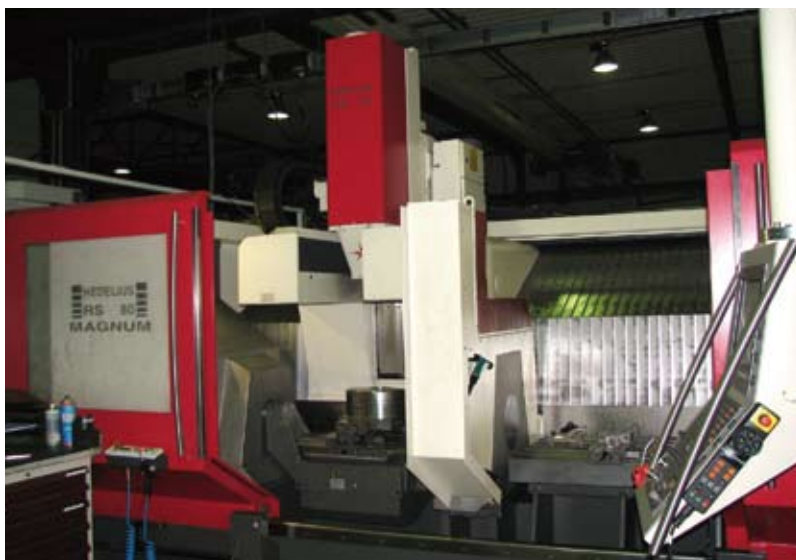
Die etwas kleinere, aber im Prinzip baugleiche RS 80 bei Lacom. Genau wie die beiden größeren Maschinen ist auch sie mit einem Magnum-Werkzeugmagazin mit ungefähr 50 Positionen ausgestattet (Bild: Jan Onk).
