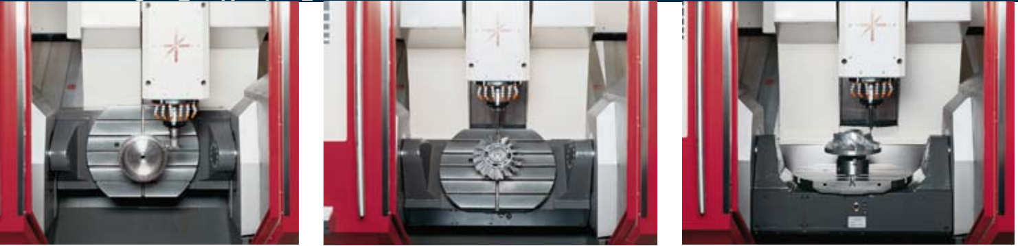
Die fünfachsige Bearbeitungsstation einer RS-Maschine von Hedelius, mit dem Dreh-/Schwenktisch in drei verschiedenen Stellungen bei der Bearbeitung eines komplexen Flügelrads (Bild: Hedelius).
