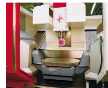
Barrières lumineuses à laser pour mesurer les pièces à usiner et en déceler les ruptures.
