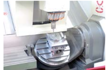
La RS 505 permet aussi bien d'usiner des pièces d'une longueur atteignant 1000 mm.
