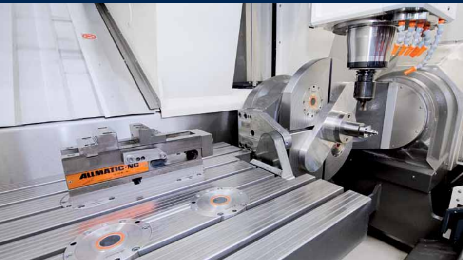
Im festen Maschinentisch und im Schwenktisch der HEDELIUS RS 605 K IC sind jeweils vier Spannzylinder integriert.
