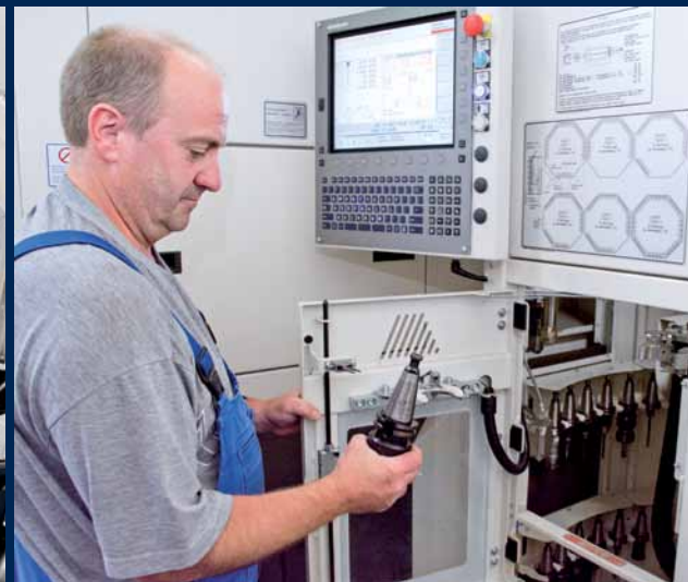
Das HEDELIUS Standby Magazin verfügt über zusätzliche 190 Werkzeugplätze.
