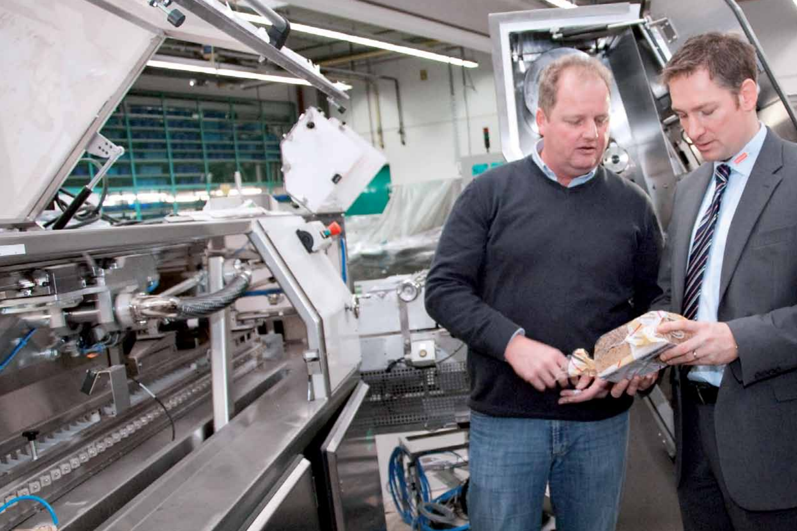
Reinhard Salmen, Abteilung Technik, im Fachgespräch mit HEDELIUS Geschäftsführer Dennis Hempelmann. Die hier gezeigte Maschine von Hartmann verpackt bis zu 4200 Brote in der Stunde.
