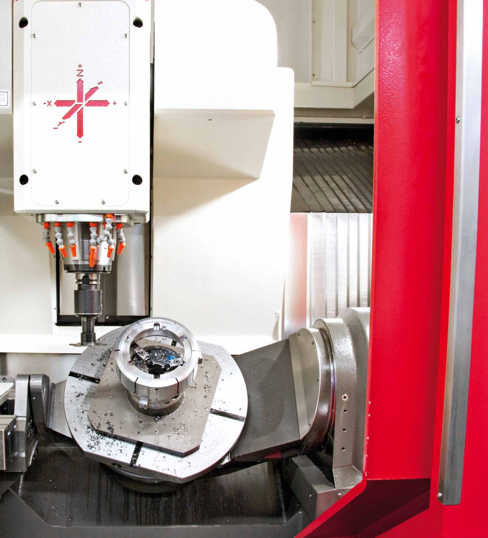
Der Dreh-Schwenktisch der RS 605 eignet sich ideal zur 5- und 6-Seiten-Bearbeitung komplexer Werkstücke. Die leistungsstarke Hauptspindel erreicht eine Drehzahl von bis zu 24000 min -1 .
