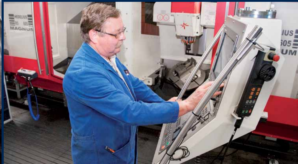
„Für Kleinserien ist die RS 605 mit Nullpunktspannsystem ideal“, findet Zerspanungsmechaniker Armin Sobisch.
