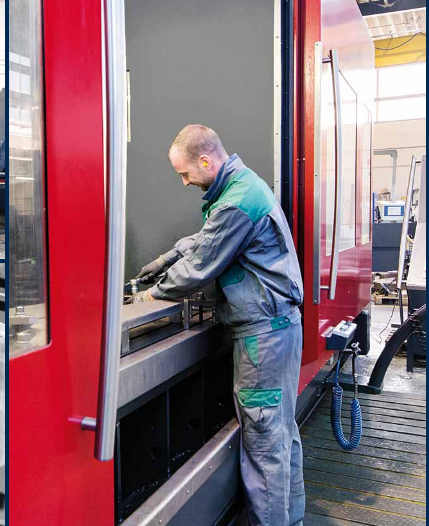
Auf der HEDELIUS T7 4200 werden Einzelteile und Kleinserien wirtschaftlich im Pendelbetrieb gefertigt.
