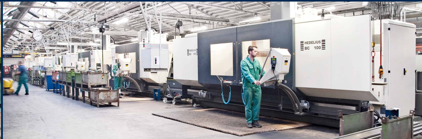
Mit der HEDELIUS BC 100 konnte die Maschinenfabrik Krone ihre Produktivität weiter erhöhen. Das Bearbeitungszentrum verfügt, je nach Modell, über einen Verfahrweg von 2500 oder 3500 mm.
