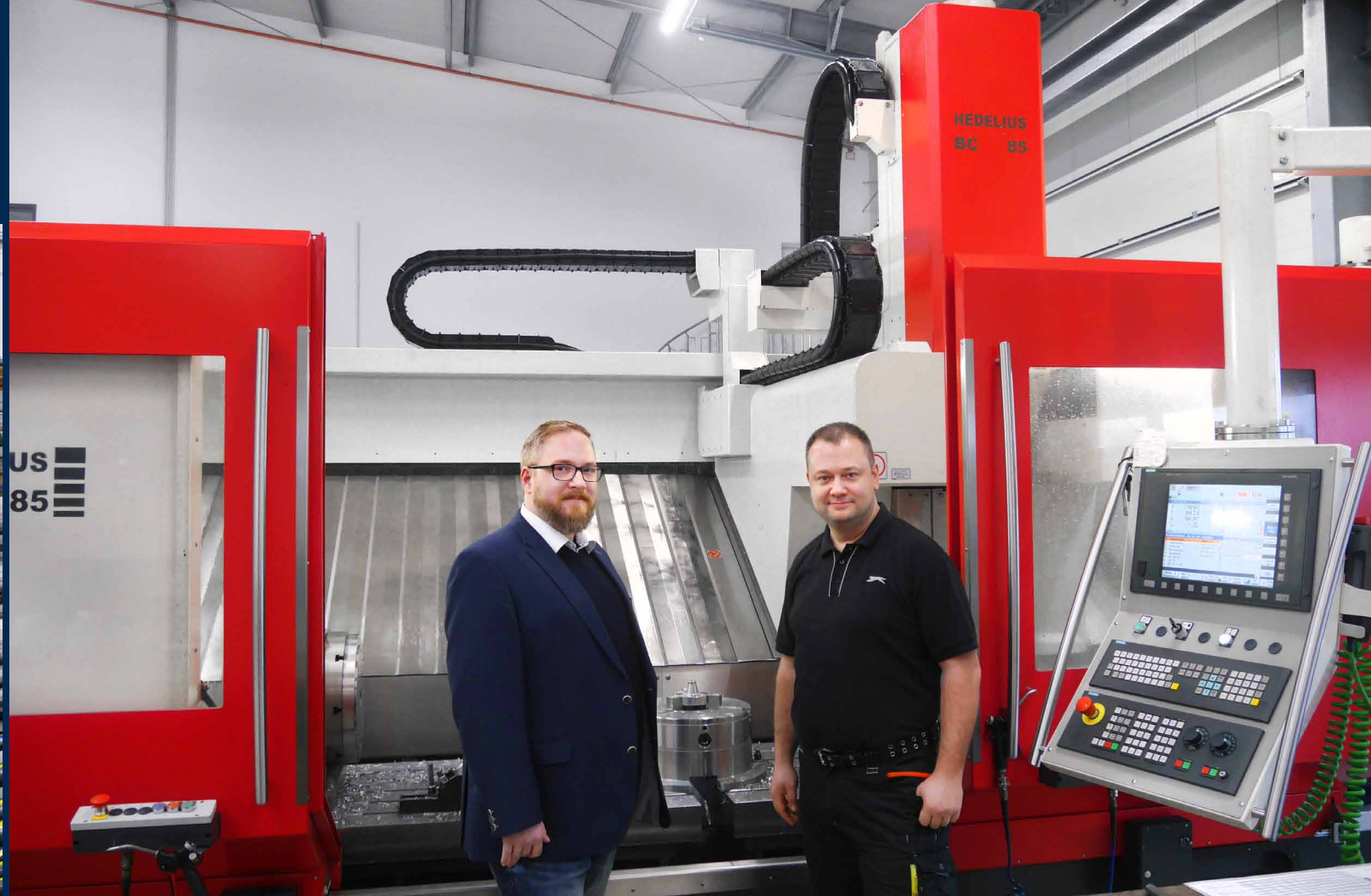
Une forte puissance pour l'usinage lourd par enlèvement de copeaux : la société AFS Fittings Service Achim GmbH & Co. KG utilise le centre d'usinage à trois axes de HEDELIUS pour la construction exigeante de conduites.
