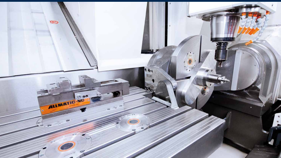
Quatre cylindres de serrage sont intégrés respectivement dans la table fixe et le plateau tournant et pivotant du centre HEDELIUS RS 605 K IC.
