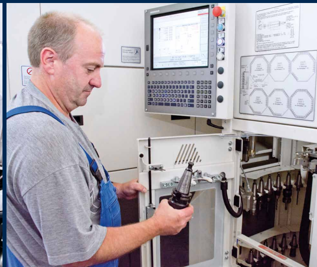
Le magasin Standby HEDELIUS dispose de 190 emplacements d'outils supplémentaires.
