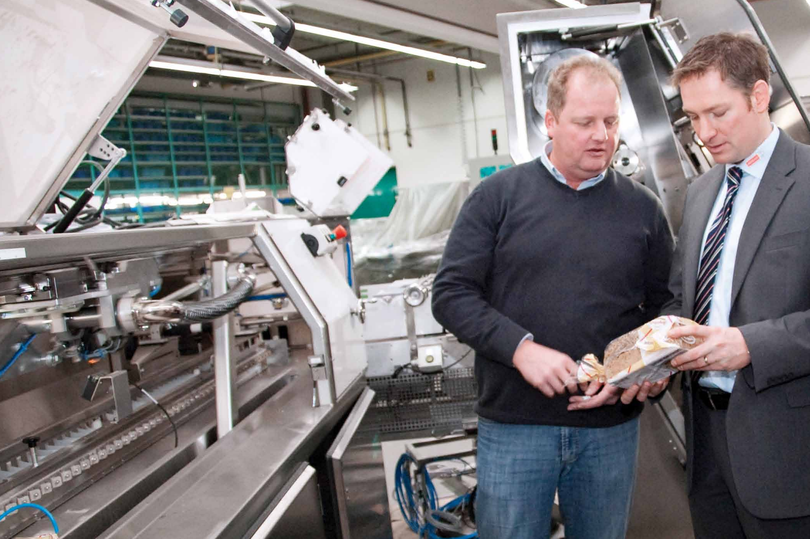
Reinhard Salmen, division Technique, en discussion technique avec le directeur de HEDELIUS Dennis Hempelmann. La machine de Hartmann représentée ici emballe jusqu'à 4200 pains à l'heure.
