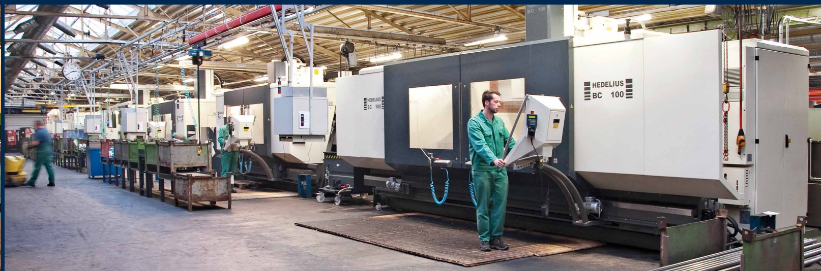
Avec le centre d'usinage BC 100 de HEDELIUS, l'entreprise de construction mécanique Krone a pu poursuivre la progression de sa productivité. Le centre d'usinage dispose, selon le modèle, d'une course d'usinage de 2500 ou 3500 mm.
