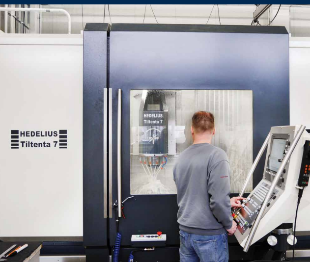
Sul centro di lavoro HEDELIUS TILTENTA 7 Single, la D+P lavora prevalentemente pezzi in alluminio.
