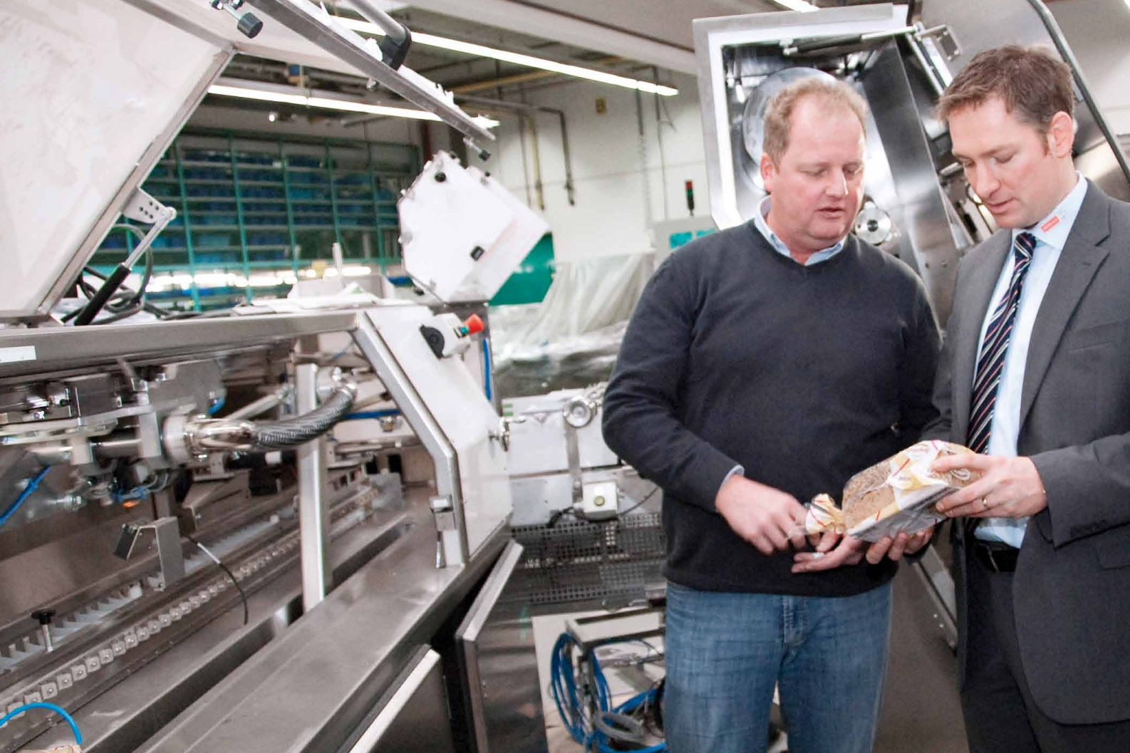
Reinhard Salmen, Reparto Tecnologia, durante una discussione tecnica con l'amministratore di HEDELIUS Dennis Hempelmann. La macchina qui raffigurata della Hartmann confeziona fino a 4.200 forme di pane l'ora.
