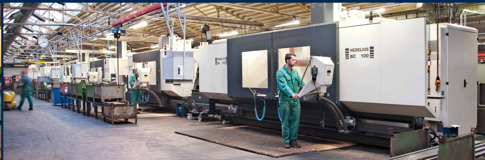
Con HEDELIUS BC 100 la fabbrica di macchine Krone poteva ulteriormente aumentare la propria produttività. Il centro di lavorazione dispone, a seconda del modello, di una corsa di 2500 o 3500 mm.
