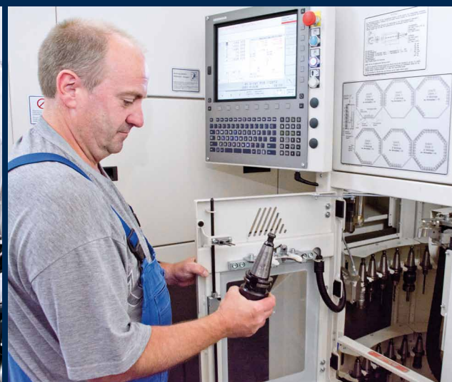
Резервный магазин HEDELIUS вмещает 190 дополнительных инструментов.
