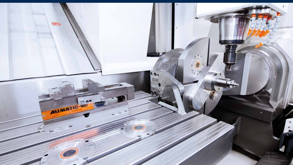
В стационарный и наклонный стол станка HEDELIUS RS 605 K IC интегрированы по четыре зажимных цилиндра.
