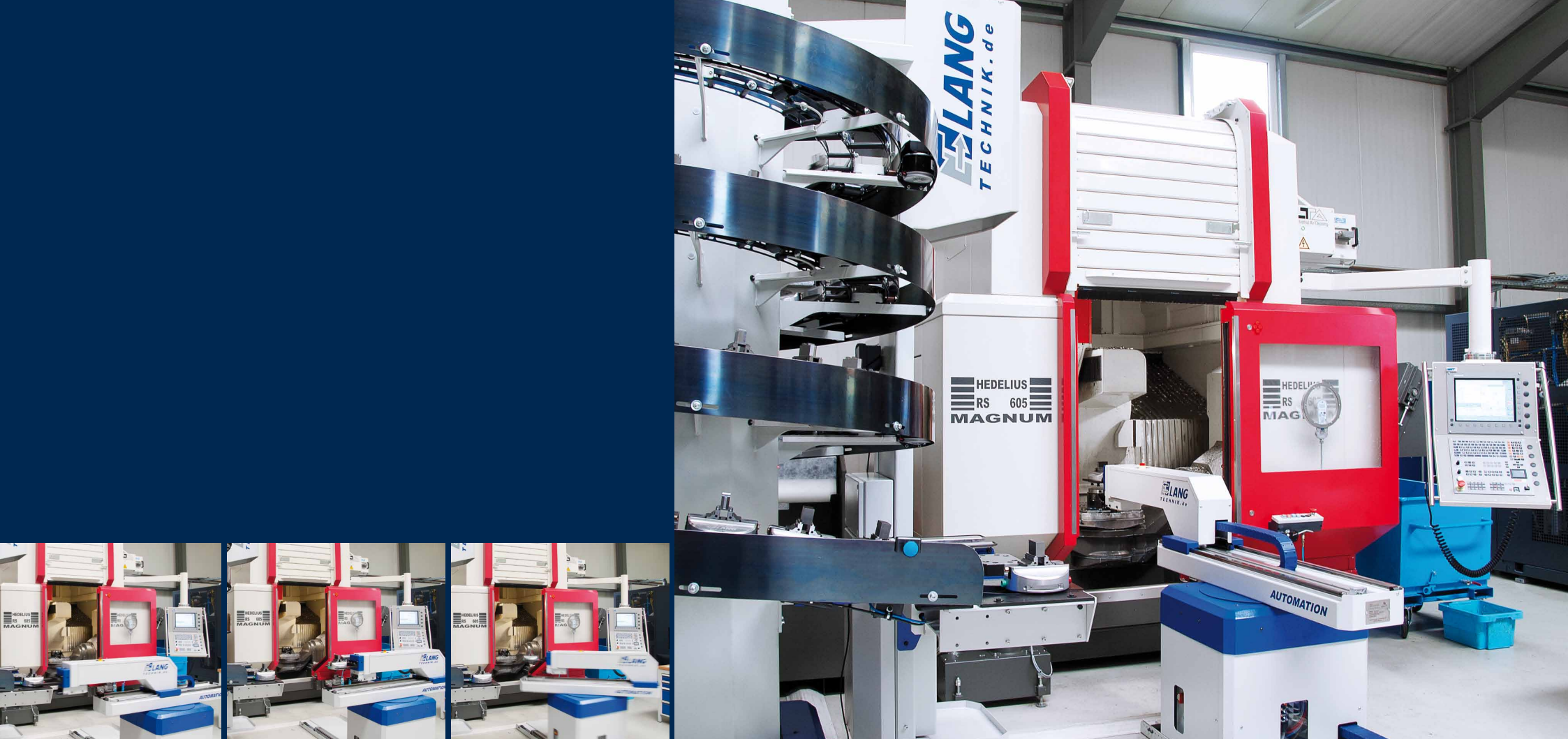
Станок HEDELIUS RS 605 оснащен современной системой автоматизации марки Lang. Загрузка поднозов с заготовками осуществляется в автоматическом режиме.
