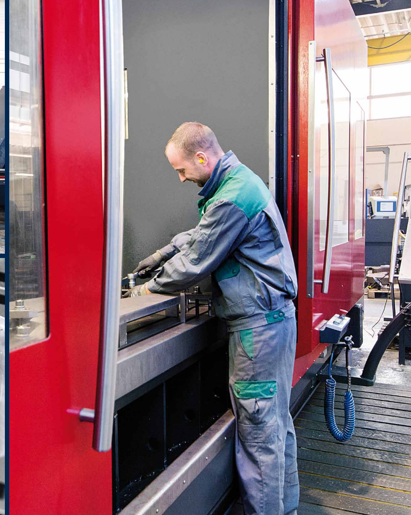
Четыре обрабатывающих центра HEDELIUS используются на гибком производстве для обработки широкого ассортимента заготовок.
