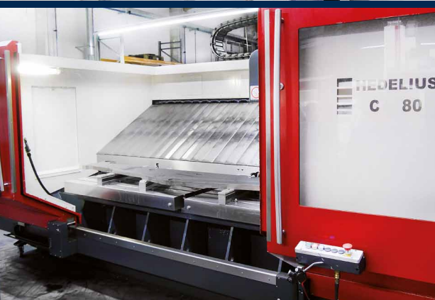
Das erste Bearbeitungszentrum von BL-Lasertechnik. Auf der C80 2300 werden Bauteile für Schweißbaugruppen mechanisch bearbeitet.
