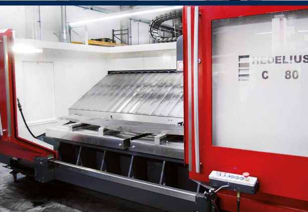
Le premier centre d'usinage de BL-Lasertechnik. Le modèle C80 2300 est utilisé pour l'usinage mécanique de composants de modules mécano-soudés.
