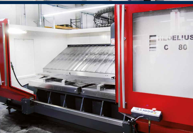
Первый обрабатывающий центр компании BL-Lasertechnik. На станке C80 2300 производится механическая обработка деталей для сварных узлов.
