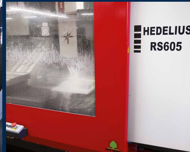
Auf der RS 605 K20 wird hauptsächlich Aluminium bearbeitet, durch den festen Maschinentisch und den Dreh-Schwenktisch wird der Rüstaufwand deutlich reduziert.
