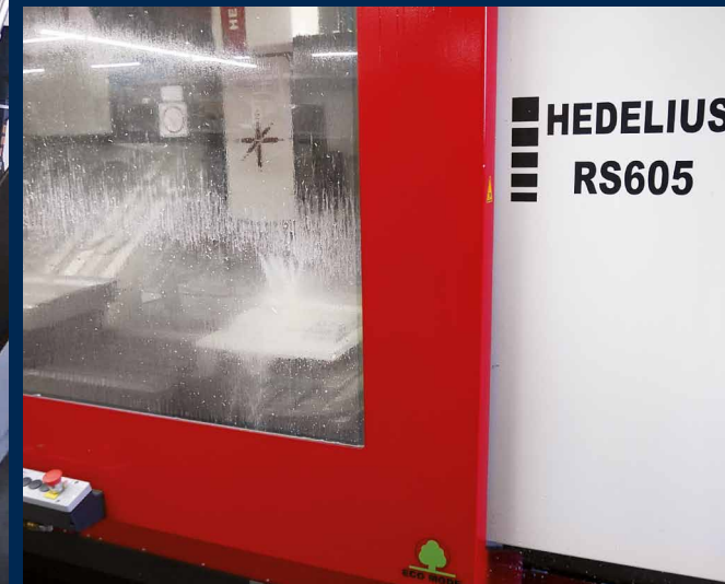
Le système RS 605 K20 est utilisé principalement pour l'usinage de l'aluminium. La table fixe et le plateau tournant-pivotant permettent de réduire sensiblement les temps de préparation.
