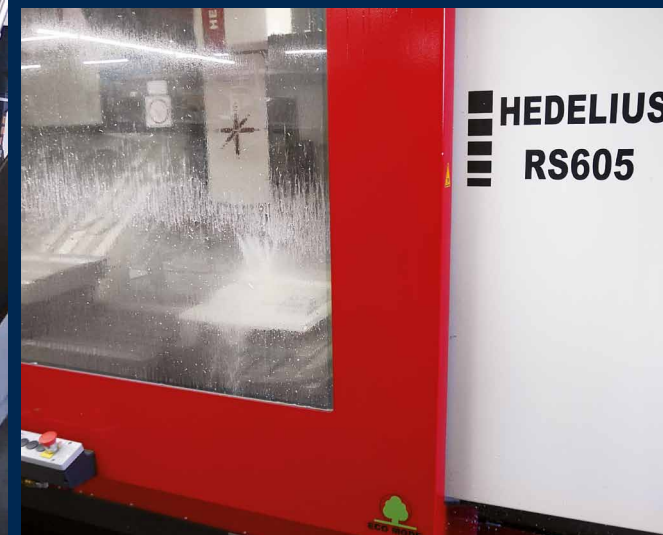
Il centro RS 605 K20 viene utilizzato soprattutto per la lavorazione dell'alluminio. Grazie alla tavola fissa e alla tavola orientabile e girevole, il tempo di attrezzaggio viene ridotto in modo considerevole.
