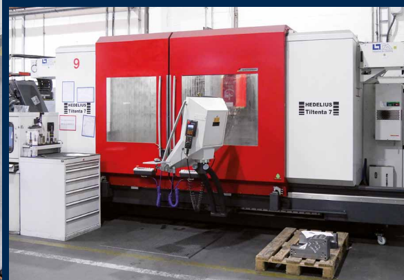
Le centre d'usinage Tiltenta 7-2600 est entièrement intégré dans la chaîne de production de SD Automotive. De petites pièces d'écartement de même que des composants volumineux, pouvant mesurer et peser jusqu'à 1400 mm et 300 kg, sont usinés sur ces solutions.
