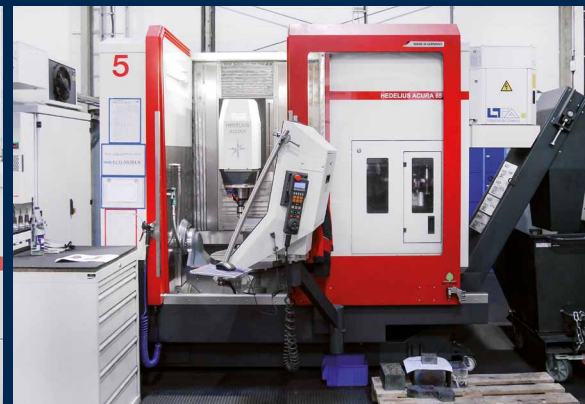
Les centres d'usinage ACURA 65 de HEDELIOUS sont utilisés notamment pour la fabrication de segments de moules et d'éléments de coupe.
