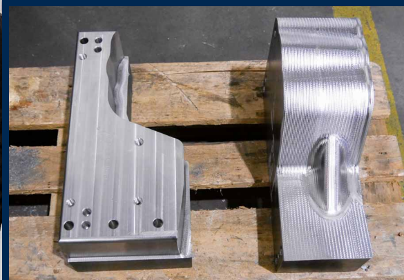
Composants pour blocs de moulage fabriqués sur les centres Tiltenta 7-2600 de HEDELIOUS.
