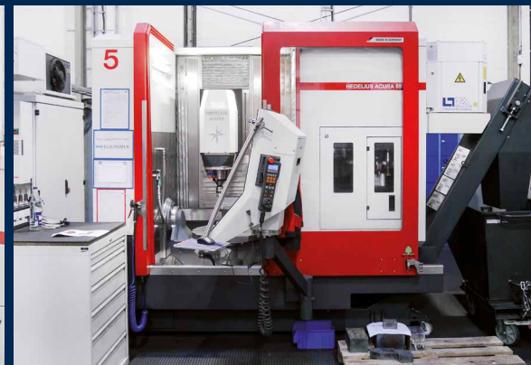
На станке ACURA 65 производства HEDELIOUS изготавливаются, в частности, сегменты форм и режущие элементы.
