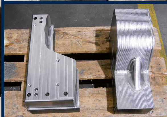
На станке Tiltenta 7-2600 от HEDELIOUS производятся также детали для фигурных зажимных кулачков патронов.
