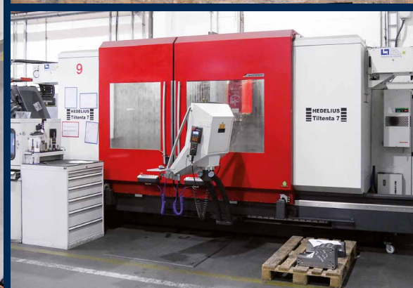
В производство компании SD Automotive станок Tiltenta 7-2600 интегрирован полностью. Обрабатываются мелкие регулировочные элементы, а также большие компоненты размером до 1 400 мм и весом до 300 кг.
