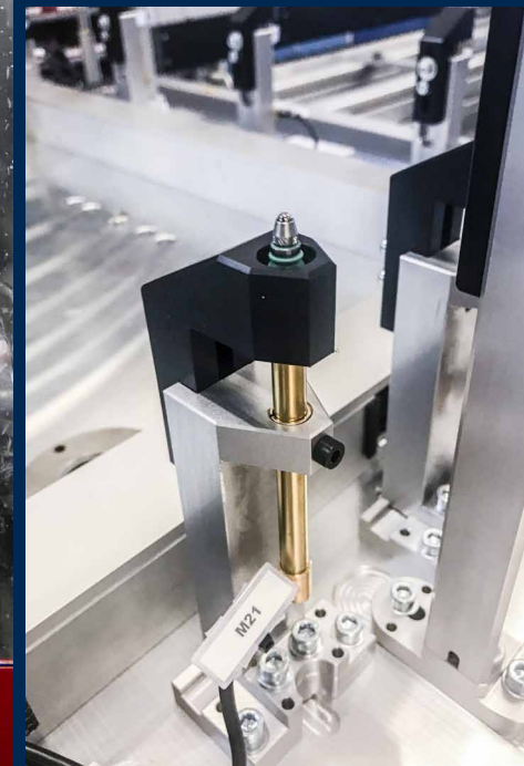
Messtasterhalter mit Schutz von Zander EMS für eine Sondermaschine für die Automobilindustrie.
