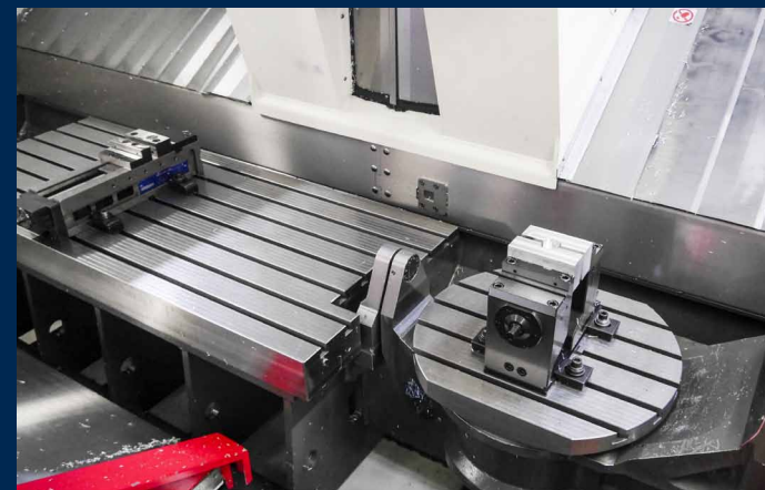
Messtasterhalter mit Schutz von Zander EMS für eine Sondermaschine für die Automobilindustrie.
