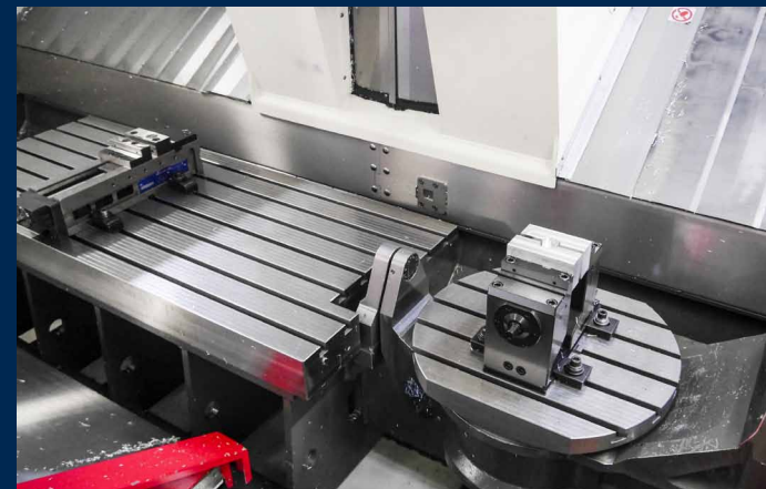
Dispositif de maintien de touche de mesure avec protection de Zander EMS pour une machine spéciale pour l'industrie automobile.
