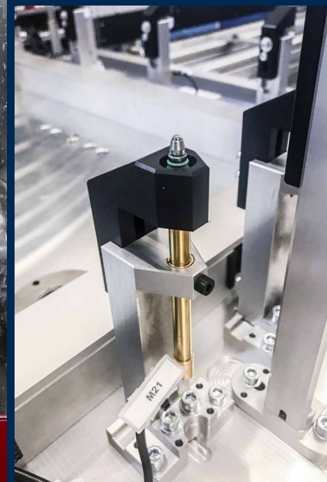
Supporto per sensore di misura con protezione di Zander EMS per una macchina speciale per l'industria automobilistica.
