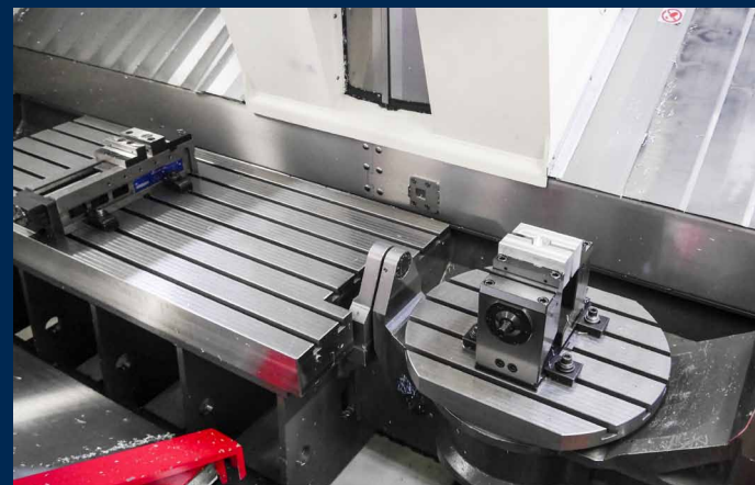
Supporto per sensore di misura con protezione di Zander EMS per una macchina speciale per l'industria automobilistica.
