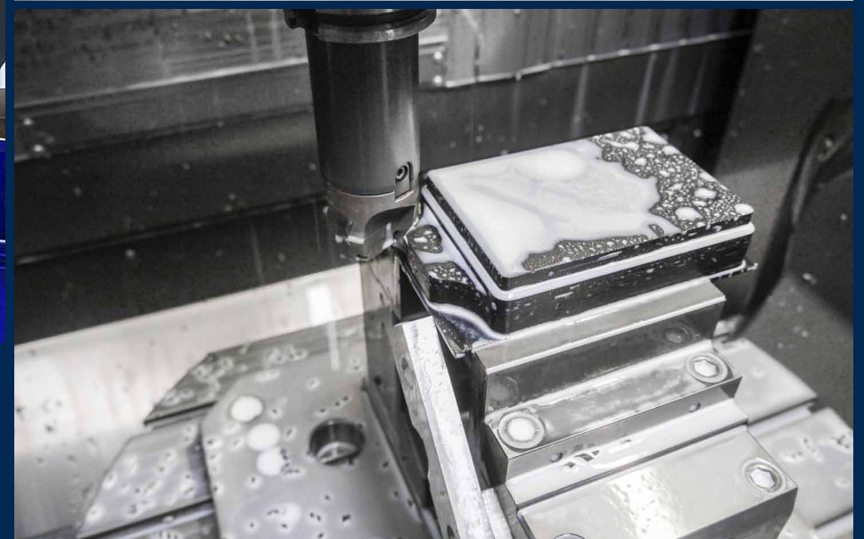
На станке ACURA 65 фирма Pfisterer производит крышки корпусов лабораторных приборов из пластмассы. Только резание алюминия производится еще чаще.
