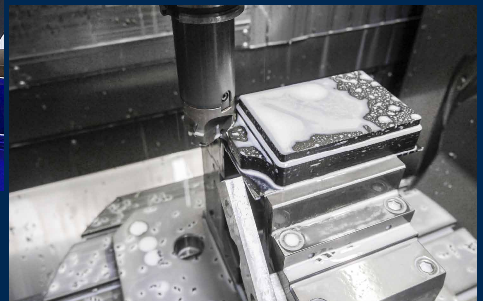
Auf der ACURA 65 werden bei Pfisterer Gehäusedeckel für Laborgeräte aus Kunststoff gefertigt. Nur Aluminium wird noch häufiger zerspannt.
