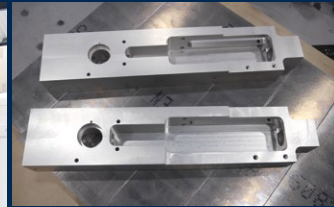
Auf der ACURA 65 EL werden vollautomatisch Aluminiumteile für Verpackungsmaschinen gefertigt. Die kleinsten Teile liegen bei Maßen von 50 x 50 x 80 mm, die größten Teile können bis zu 700 mm lang sein.
