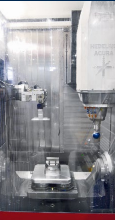
Die Beladung der ACURA 65 EL erfolgt durch die 900 x 720 mm große, seitliche Beladeöffnung.
