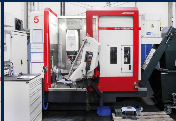
Auf den ACURA 65 von HEDELIUS werden unter anderem Formensegmente und Schneidelemente gefertigt.
