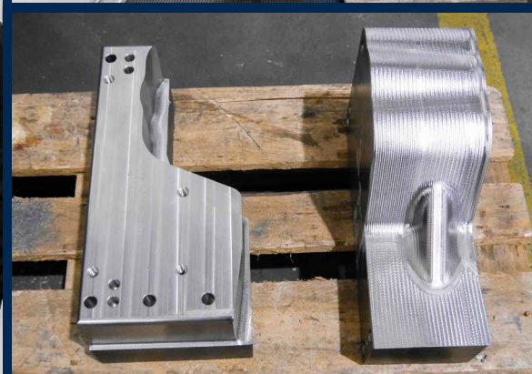
Auf den Tiltenta 7-2600 von HEDELIUS werden auch Bauteile für Formbacken hergestellt.
