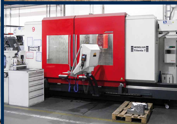
In die Produktion von SD Automotive voll integriert ist die Tiltenta 7-2600. Kleine Distanzstücke genauso wie große Bauteile bis 1400 mm und 300 kg werden bearbeitet.
